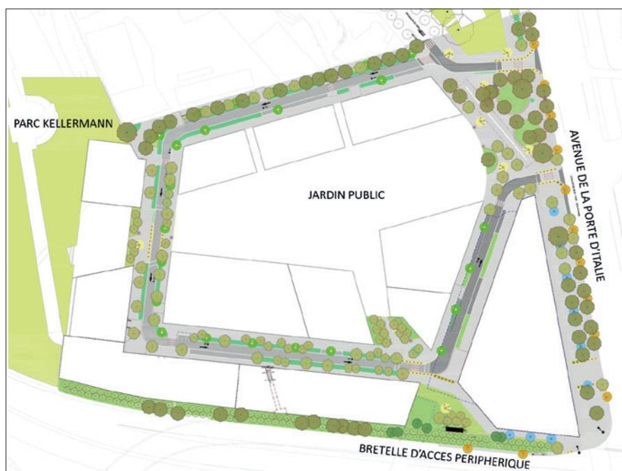
ZAC Paul Bourget : le projet d'espaces publics (noues plantées et chaussées en pavés béton) permet d'infiltrer 55% de la pluie 16 mm.
